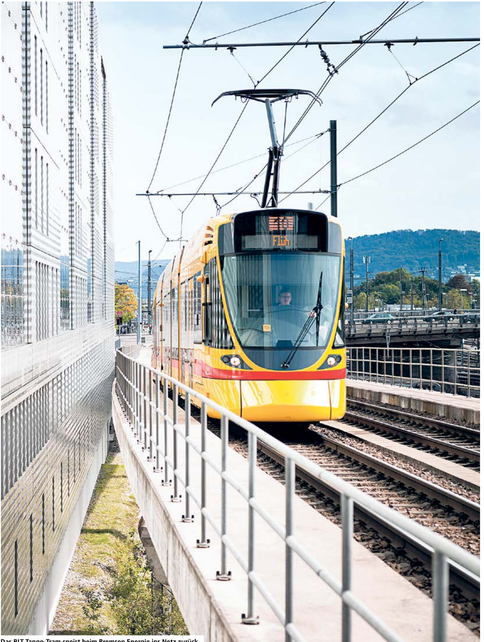
Das BLT Tango-Tram speist beim Bremsen Energie ins Netz zurück.
